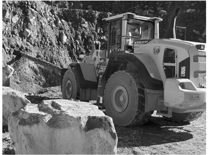
Der Blausee-Kieselkalk wird aus Findlingen gewonnen, die mit Hilfe von Stocherstangen aus der Humus- und Geröllschicht herausgelöst werden.
